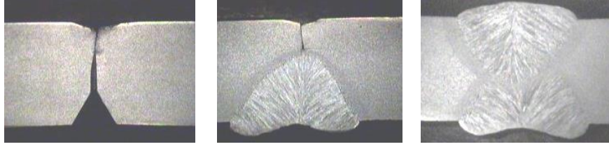
Şekil 3. 1422x12,5 mm ebatlı boruda kaynak dikişinin oluşumu.
