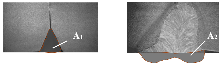
Şekil 4.24. Kaynak ağzı ve kaynak kepi kesitinin şematik gösterimi.
