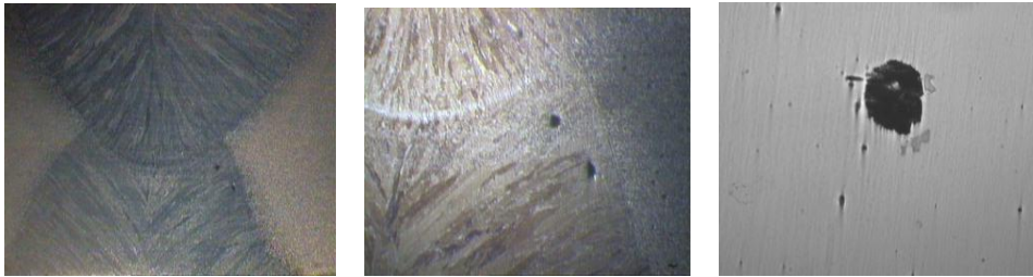
Şekil 2.25. Kalıntı türü kaynak hatasının görünümü.
